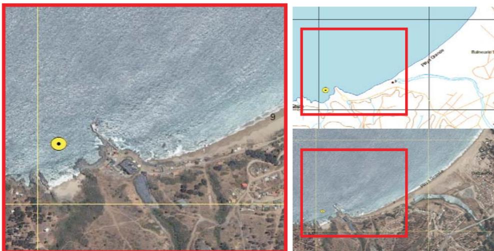
Obtenida la imagen con la posición del elemento se da paso a la ortorectificación de la misma, para ello se debe contar con los puntos de control o cartografía que posea puntos de control, estos están disponibles a través de todo Chile como puntos monumentados y pueden ser adquiridos en el IGM, o bien en otras instituciones publicas, a través de estos se puede llevar a cabo fácilmente la ortorectificación de la imagen, lo cual permite corregir la imagen de acuerdo a los parámetros de
